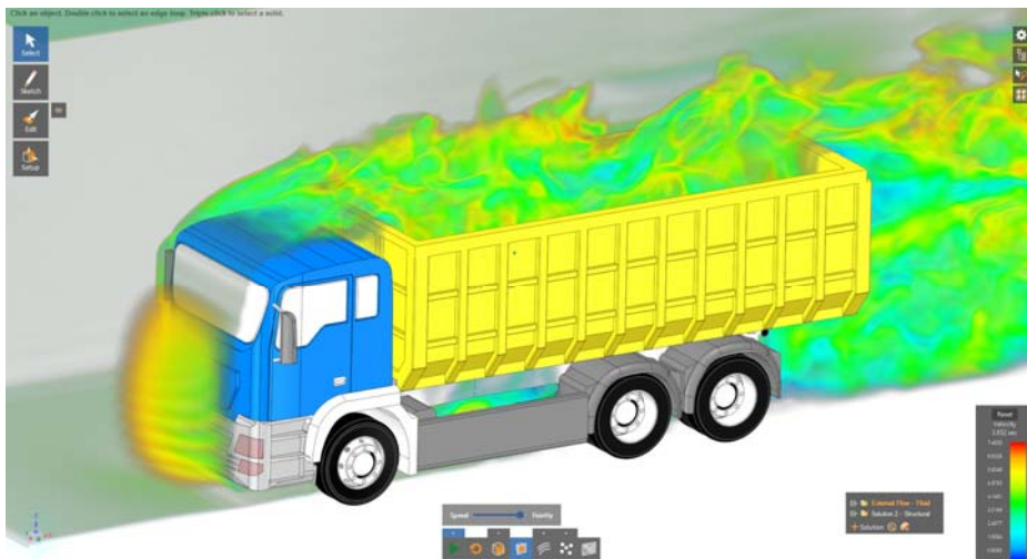
トラックの外部における空気の流れ・形状変更した影響を瞬時に確認可能
