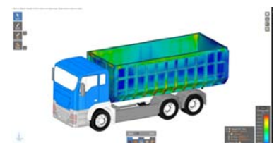
トラックの荷台の応力解析
